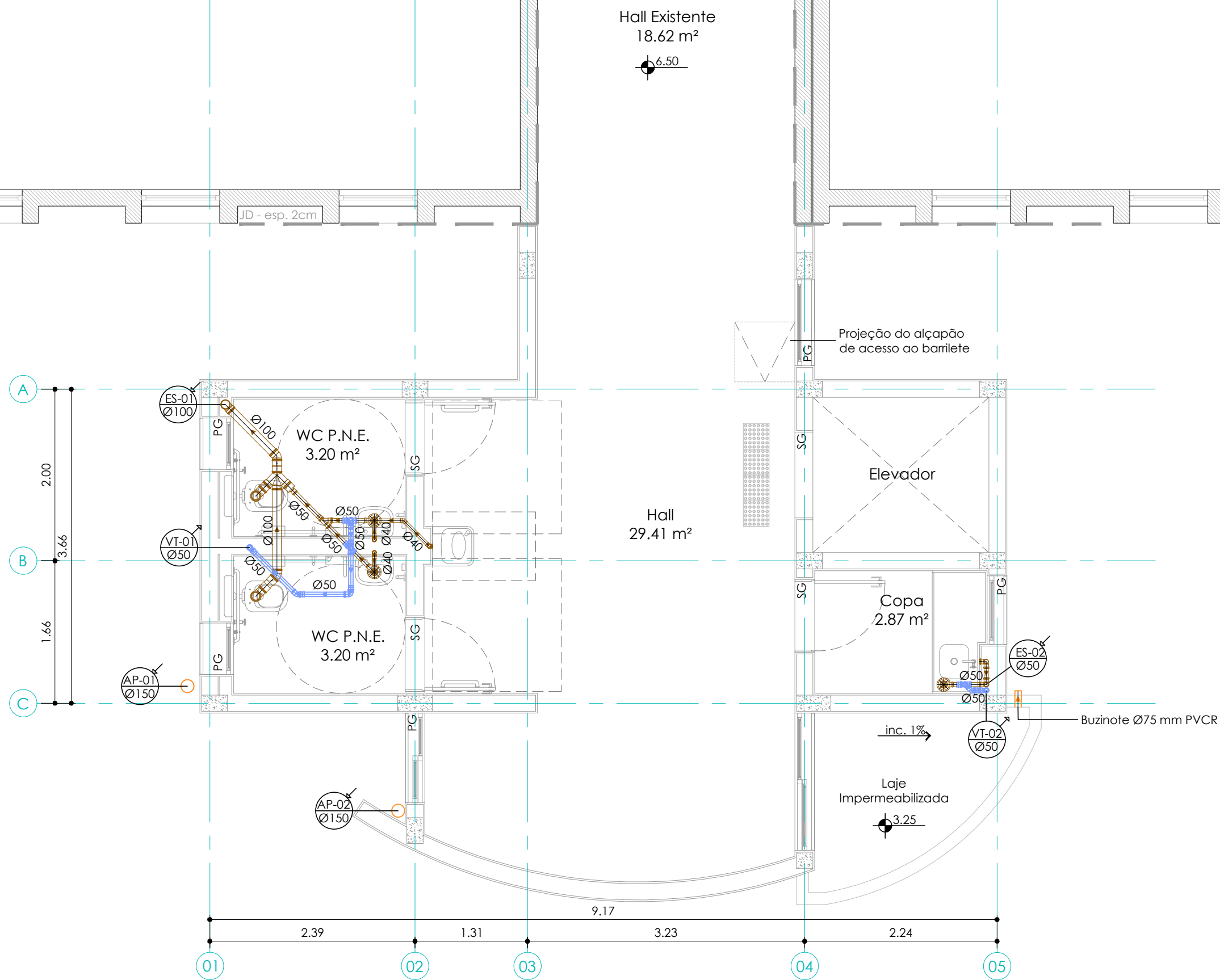
PLANTA PRIMEIRO E SEGUNDO PAVIMENTO Cota do 1º Pav: +3,25 Cota do 2º Pav: +6,50 Escala 1:50
