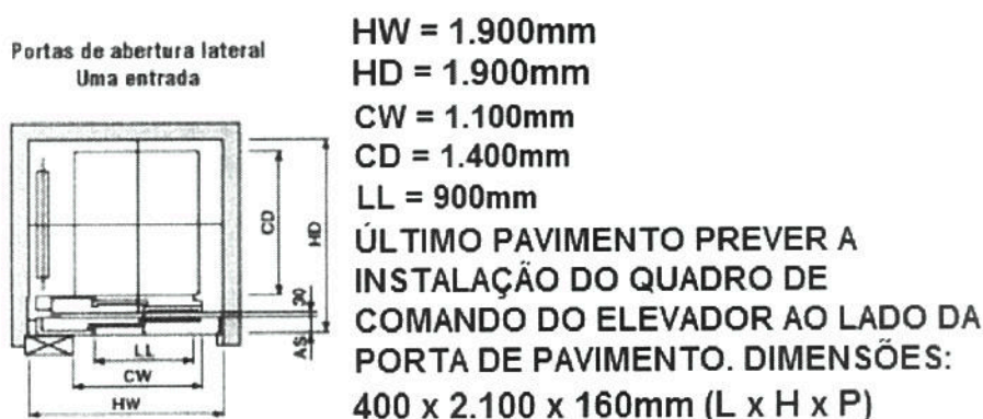
Figura 1 – Croqui em corte da caixa de corrida do elevador sugerindo posicionamento de componentes e estabelecendo requisitos dimensionais em sua seção transversal
