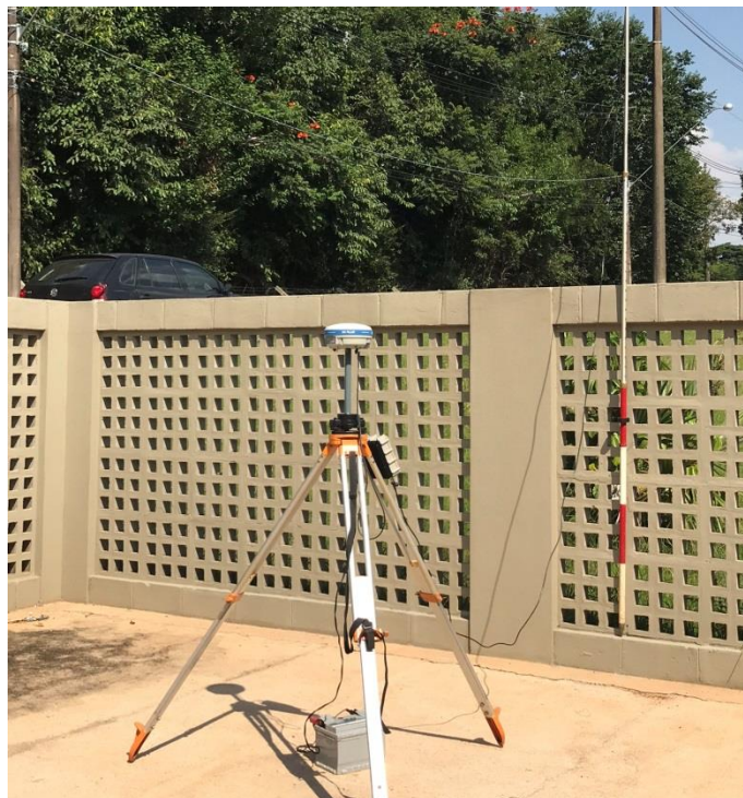
Figura 6. Equipamento utilizado para levantamento topográfico.
