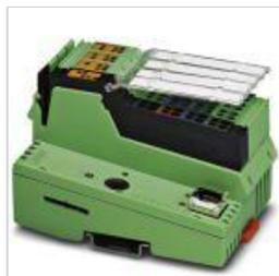
O controlador Inline oferece a possibilidade de comunicar através de PROFINET e Modbus/TCP. A programação é feita com o PC Worx Express ou PC Worx (IEC 61131-3).
