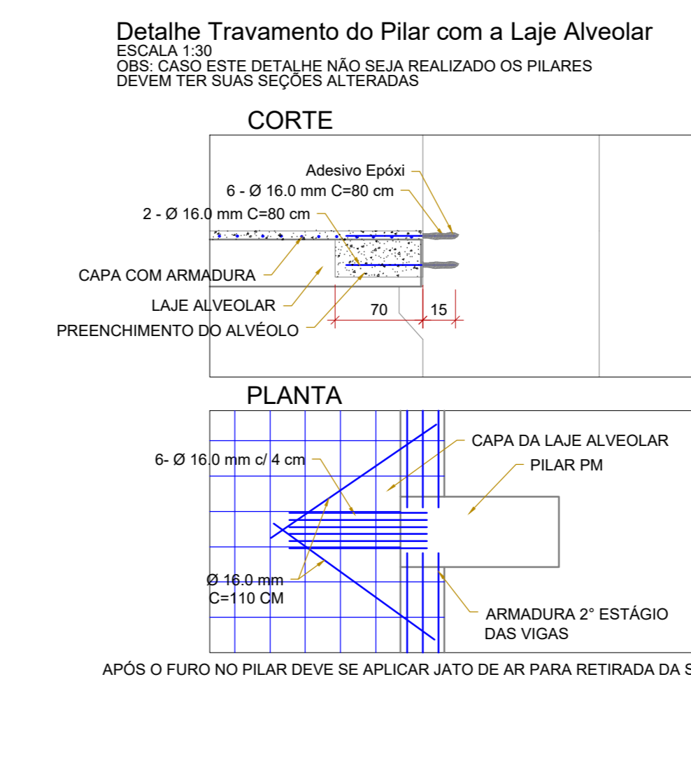
Detalhe Travessamento do Pilar com a Laje Alveolar
